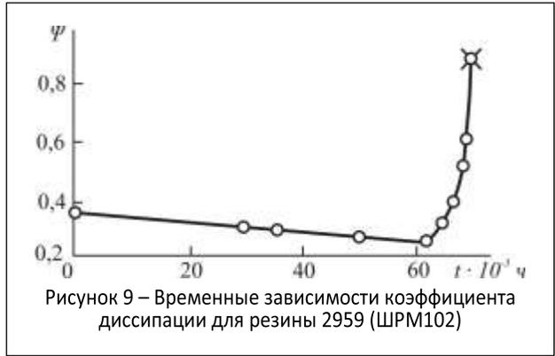
Рисунок 9 – Временные зависимости коэффициента диссипации для резины 2959 (ШРМ102)
